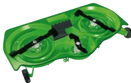
Třínožový systém zaručuje dokonalé posekání středu sečeného pruhu. Žací ústrojí lze snadno demontovat bez použití nářadí.
