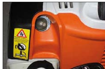
Manuální palivové čerpadlo je snadno dostupné a přitom chráněné před nechtěným stisknutím.
