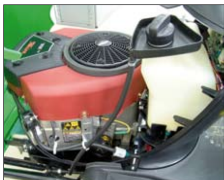
Traktor pohání spolehlivý vidlicový dvouválec Briggs & Stratton model 44 o obsahu 725 cm 3 a výkonu 12,3 kW při 2500 ot./min.
