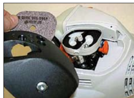
Vzduchový filtr je snadno demontovatelný. Jeho součásti lze rychle zkontrolovat a případně vyměnit.
