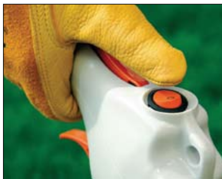
Manuální palivové čerpadlo je snadno dostupné a přitom chráněné před nechtěným stisknutím.
